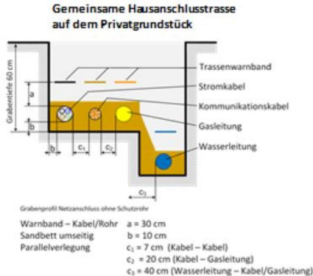
Die Kabel im Kabelgraben sind steinfrei einzusanden. Im Allgemeinen dürfen Kabeltrassen nicht überbaut werden (außer bei Kabelverlegungen im Schutzrohr) und es dürfen keine tief wurzelnden Pflanzen vorhanden sein.
