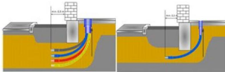
Gebäudeeinführungen sind nach den geltenden Vorschriften für Bauwerksdurchdringung und deren Abdichtung für erdverlegte Leitungen auszuführen. Die Gebäudeeinführung ist Bestandteil des Gebäudes. Für den Einbau und die Abdichtung ist der Anschlussnehmer verantwortlich.
