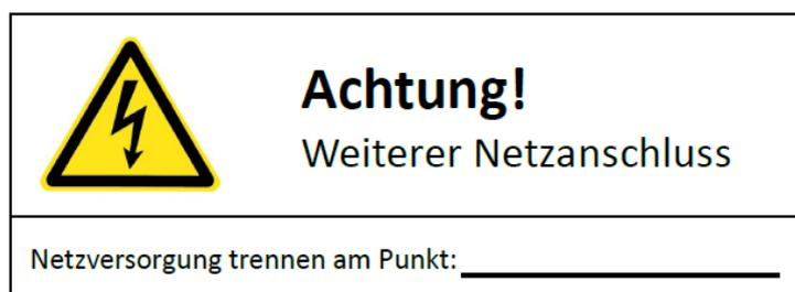
Bei mehreren Kundenanlagen in einem Gebäude, bzw. auf einem Grundstück mit je einem Netzanschluss ist eine räumliche Trennung erforderlich. Dies könnte durch eigene Anschlussräume,- einrichtungen oder Abschrankungen erfolgen.
