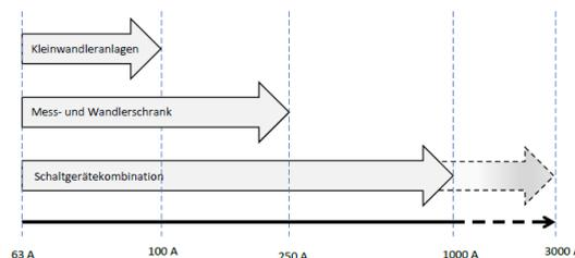
Zählerschrankkombinationen mit Zählerplätzen nach DIN VDE 0603-2-1 sind für Direktmessung bis max. 63A geeignet, darüber hinaus sind halbindirekte Messungen einzusetzen.
